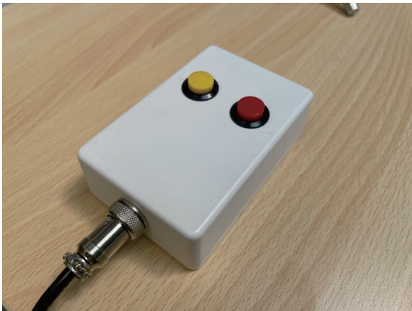
図10 非常時にドームをホームポジションに戻すためのハンドパッド
