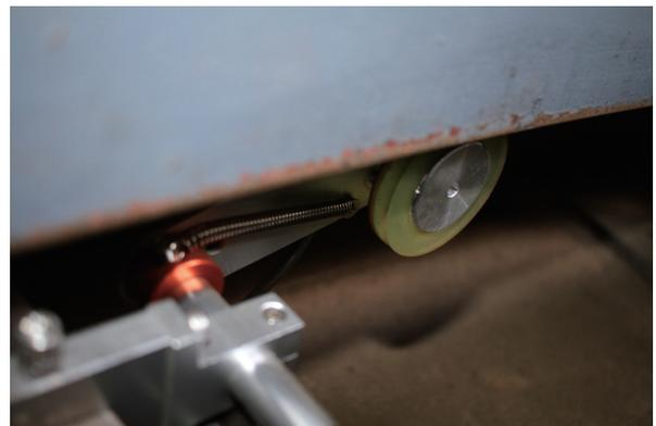
図12 ドームの回転を検知するロータリーエンコーダー
