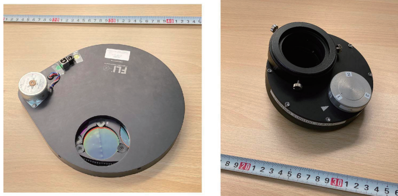
図4 (左) 主フィルターホイールと, (右) 副フィルターホイール
