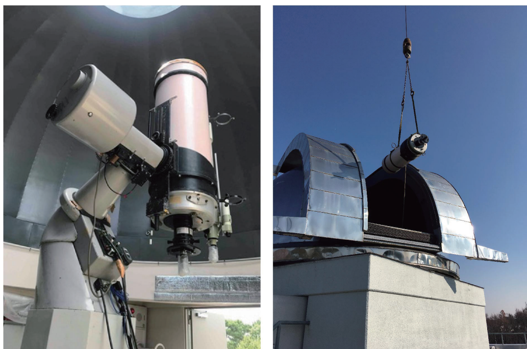
図1 (左) 旧40cm鏡と、(右) 6mドームのスリットからの搬出途中の鏡筒
