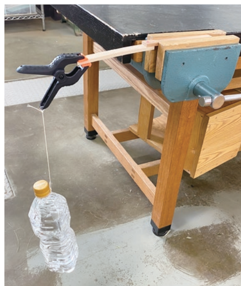
図7 接着剤の圧着における強度実験
