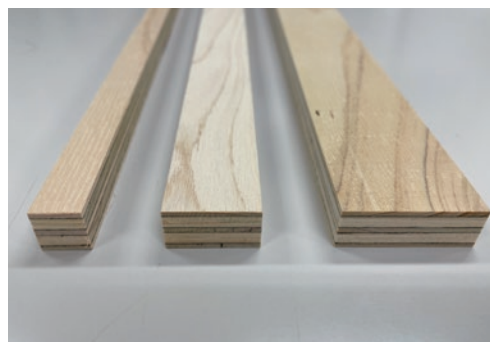
図1 合板の規格材の断面図
