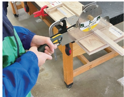
図8 治具を用いた合板規格材の切断の様子
