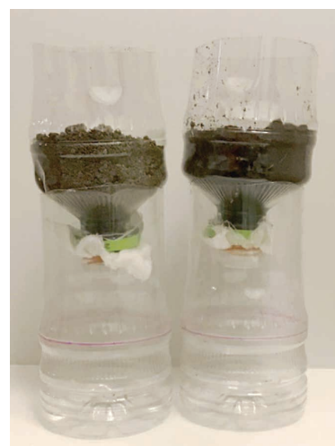
図2 2つに切ったペットボトル。飲み口にガーゼと輪ゴムで蓋をして、砂(左)や土(右)を入れてペットボトルの下半分に乗せる。上から水を注ぐと水が染み込む様子や湿った砂や土の様子を観察することができ、加えて通り抜ける水量の違いから保水量の差を考察することができる。
