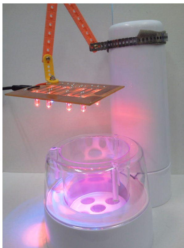
図 3-9 養液栽培装置用 LED 光源を用いた簡易養液栽培装置
