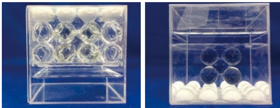
図8 クリアスフィアを用いた体心立方格子構造モデル (左) 結晶構造部分に水を入れていない状態 (右) 結晶構造部分に水を入れた状態
