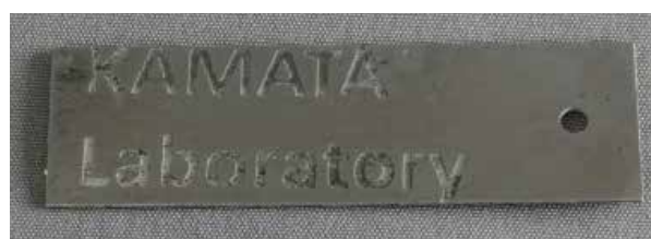
図10 転写シールのコーティングで作ったネームプレート
