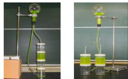
図 5.3.2 水池の様子(左: 電池直列, 右: 電池並列)
