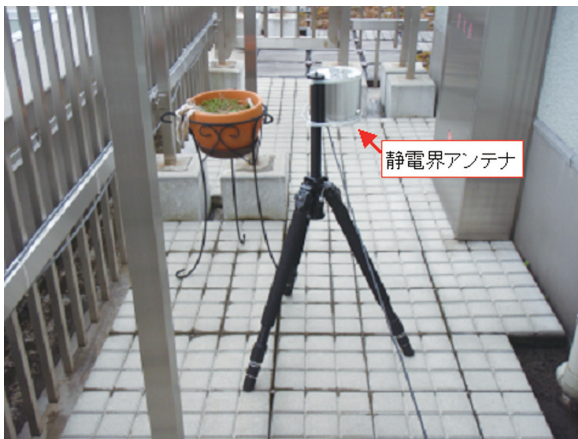
図5 試験観測時の静電界アンテナの設置状況 EPセンサは銀色のケースの内部に格納している。
