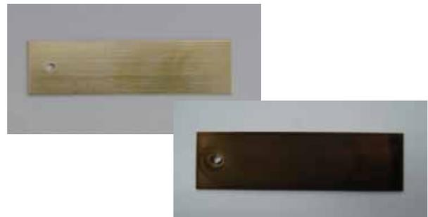
写真3 加工前の黄銅板 (上: クレンザー洗浄後, 下: グラント塗布乾燥後)
