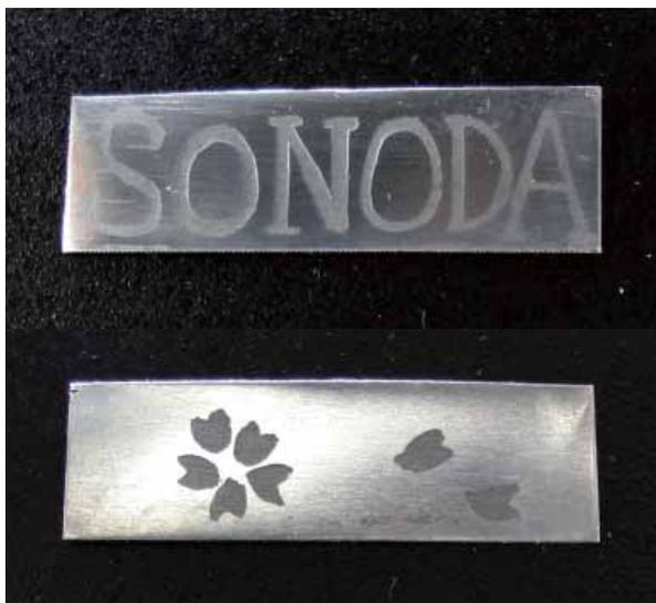
写真2 完成したネームプレート (3倍希釈の塩酸, 45°Cで5分間エッチング)
