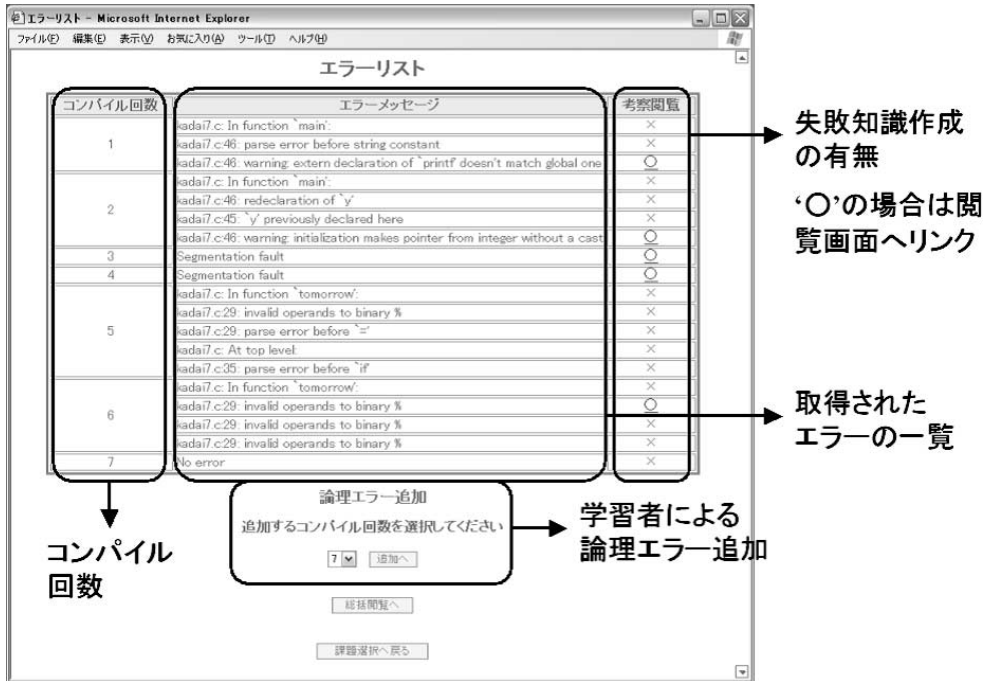
図 2 エラーリスト表示画面 Fig. 2 The screen shot of the error list.
